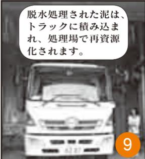
脱水処理された泥は、トラックに積み込まれ、処理場で再資源化されます。
