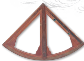
左：象限儀(小) 坂の傾斜 角を測るための器具 右：垂揺球儀 天体観測に 使用した振り子時計
