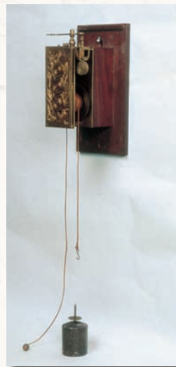
測触定分儀(そくしよくていぶんぎ) 望遠鏡の筒に挿入して、日食・月食の進行状況を測定した器具。
