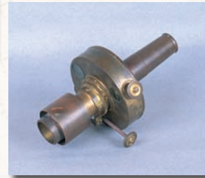
測触定分儀(そくしよくていぶんぎ) 望遠鏡の筒に挿入して、日食・月食の進行状況を測定した器具。
