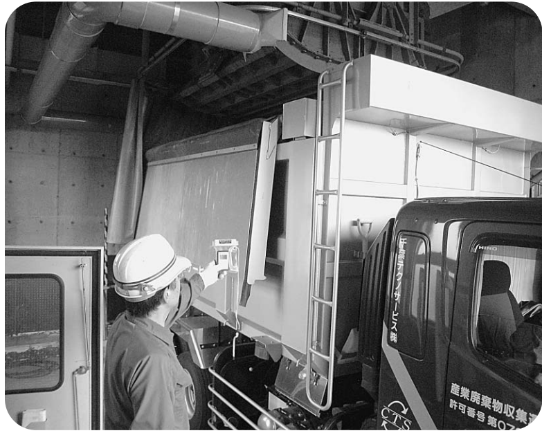
放射線量を測定しながら下水道汚泥の積み込み
