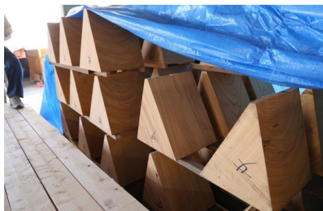
下川岸区 コマ材のカット状況
