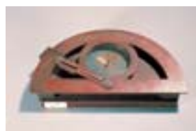
半円方位盤 遠くの間や島までの方位を測る方位盤。
