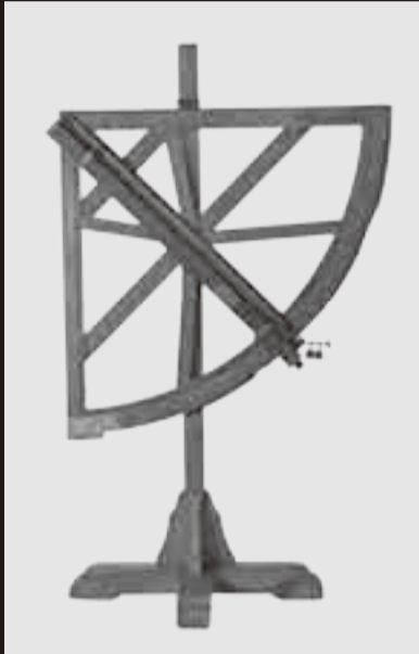
象限儀(中) 北極星などの高度を測つた器具。
